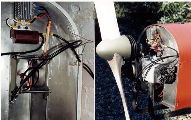
Triebwerks-Einbau mit ursprünglichen Holzpropeller
